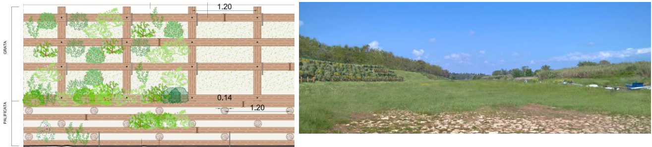
Figura3 – Interventi Ingegneria naturalistica: prospetto palificata/grata e rendering dello stato di progetto
