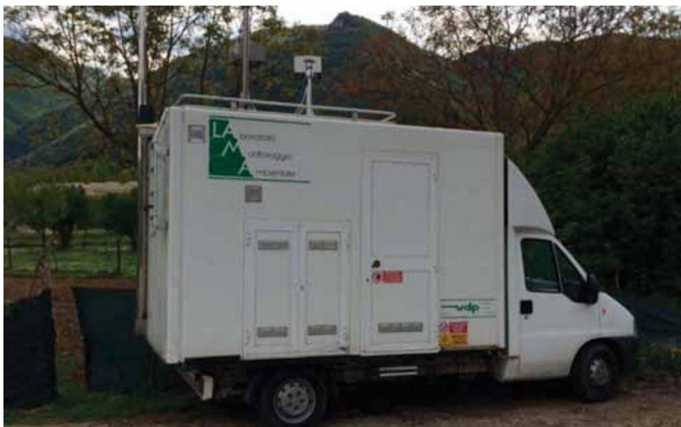
Figura 4-2 Esempio di laboratorio mobile per il monitoraggio ambientale
