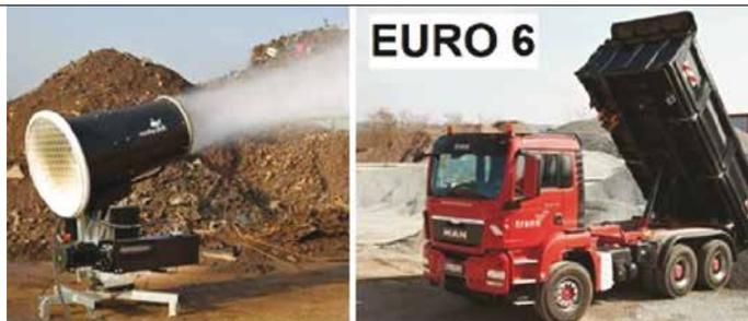
5. Cannoni nebulizzatori per l'abbattimento delle polveri e bagnatura delle aree in cui si opera, durante le attività di maggior produzione di polveri, ad esempio scavature o stoccaggio.
